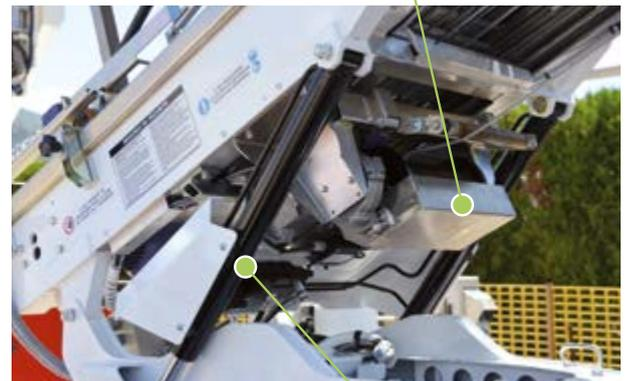
Doble cilindro de elevación reforzado
