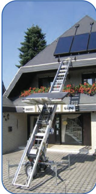
Altura de elevación hasta 18 Mt
